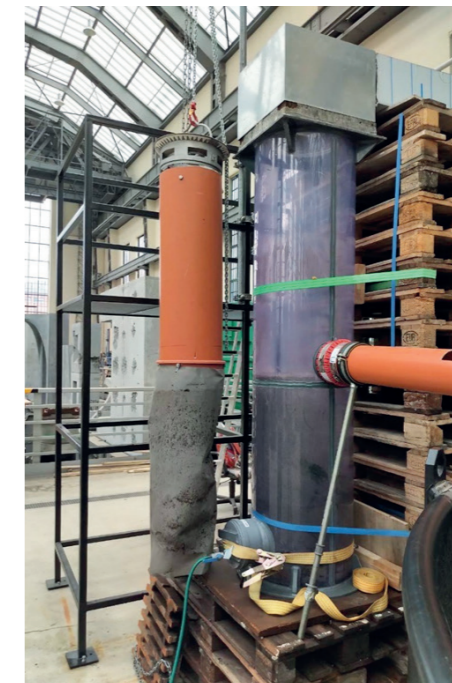
Bild 2 Das Modul Trichter mit Filterrock hat in den praktischen Versuchen am besten abgeschnitten. Quelle: Wegmann/TU Berlin
