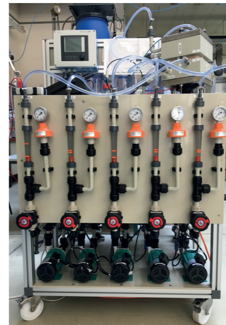
Bild 2 Aufbau der EDM-Anlage Quelle: Rau/TU Berlin
