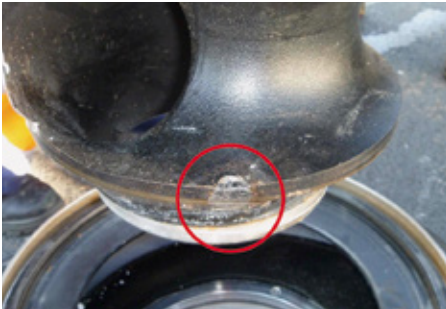
Bild 4 Modifizierung der SE1 durch Verschweißen der Öffnungen im Laufrad
