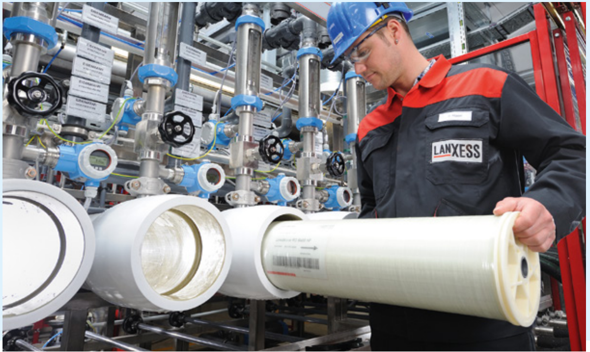
Bild 1 Am Standort Bitterfeld produziert LANXESS Umkehrosiose-Membranelemente. Zur Qualitätssicherung wird jedes Produkt vor der Auslieferung in einem Element-Tester überprüft.
