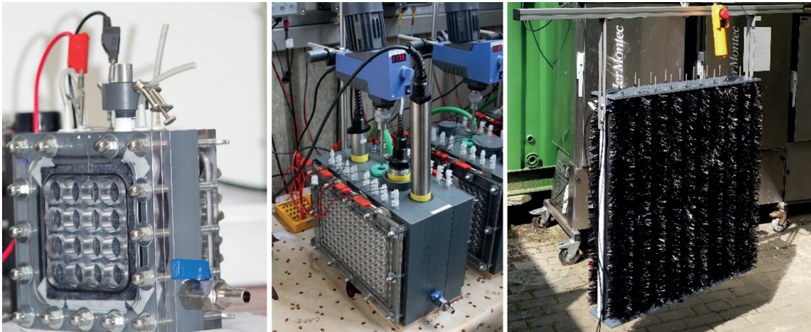
Bild 1 Die drei untersuchten Skalierungsstufen der Einkammer-MBZ Konfiguration (0,3 l; 4 x 11,2 l; eintauchbares 255 l MBZ-Elektrodenmodul v.l.n.r.).
